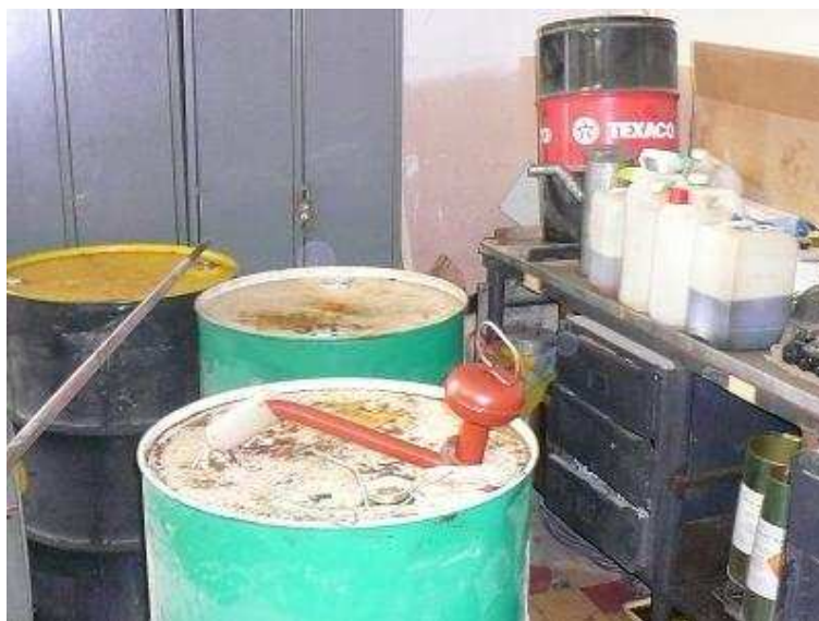
Obr. 6. 3: Nesprávné uložení hořlavých kapalin [10].
